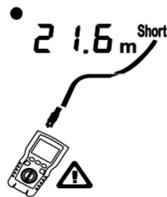
Figura 6.16 Corto en cableado coaxial
