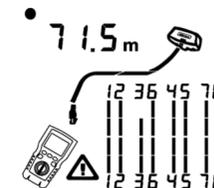
Figura 6.2 Abierto en cableado de par trenzado
