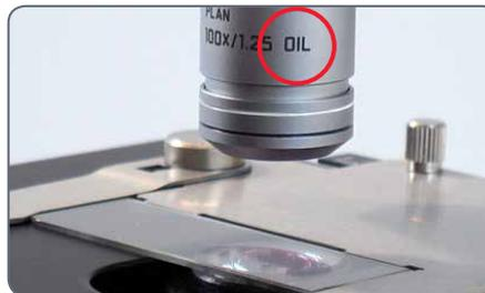
5. Eleve ligeramente el filtro usando el botón de enfoque macrométrico hasta que la gota de aceite del filtro de prueba quede en contacto con la parte frontal de la lente del objetivo de inmersión en aceite.
