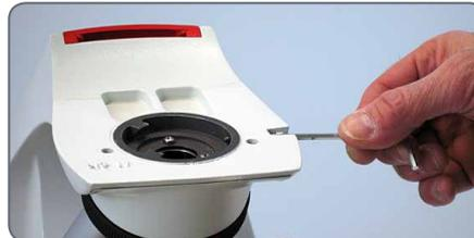
2. Introduzca la cola de milano en la base del estativo y apriete el tornillo de ajuste sin forzarlo. De esta forma colocará de forma precisa el tubo visor en el eje óptico del microscopio, independientemente de la rotación deseada.
