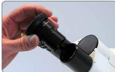
2. Ajuste los oculares en los tubos visores apretando los tornillos plateados situados en la parte inferior de los tubos visores con un destornillador de cruz (Phillips) estándar (no suministrado).
