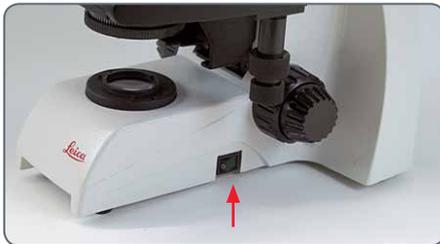
*El interruptor de encendido/apagado está situado en la parte inferior derecha del estativo*
