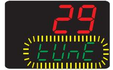
La autooptimización está terminada cuando la indicación cambia automáticamente a una indicación normal. La duración de la autooptimización depende del tramo de regulación.
