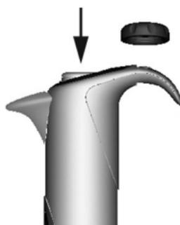
I filtri per cono possono essere rimossi attraverso l'apposito espulsore senza la necessità di toccarli con le mani. Rimuovere il cappuccio del pulsante di comando ed espellere il filtro premendo il pulsante di comando. Assicurarsi che il filtro venga smaltito negli appositi contenitori. Pulire eventualmente il cono del puntale ed inserire il nuovo filtro.
