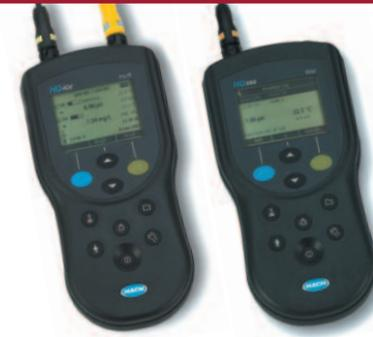
Diseñado para las aplicaciones de agua, las sondas inteligentes de HQd de Hach reconocen automáticamente el parámetro de prueba, el historial de calibración y las configuraciones de método para reducir los errores y el tiempo de configuración.
